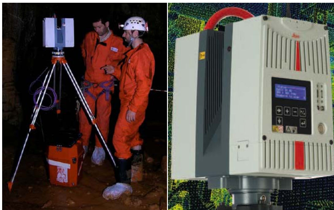
Figure 4. Mise en place et détail du scanner de numérisation à hautes vitesses et précisions, utilisé pour l'échantillonnage de la population de spéléothèmes.
